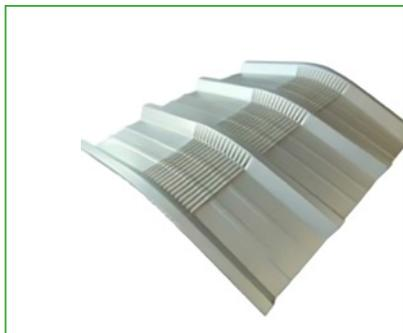
La cumbrera es una pieza utilizada para unir las dos aguas de una cubierta. Puede ser fabricado en base a la geometría del panel tipo AT4/PV4 (Consultar por otras geometrías) calzando perfectamente en la cubierta.
